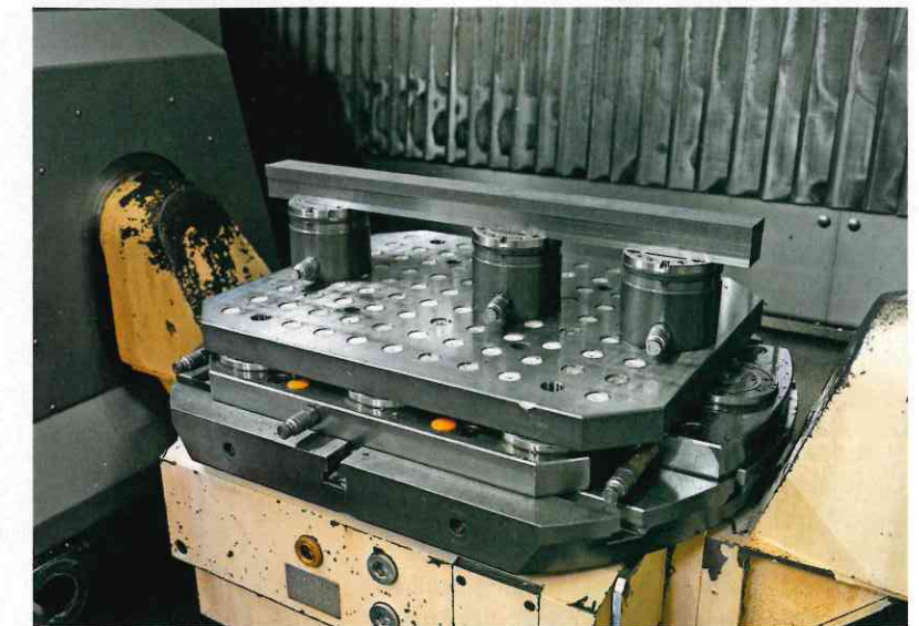
Obwohl AMF-Nullpunktspannmodule große Kräfte aufbringen, bauen sie nicht sehr hoch.
